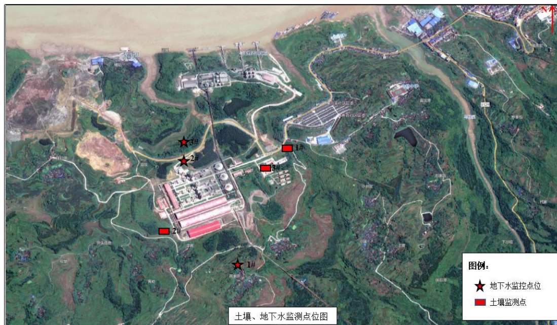
图 7.1 土壤、地下水监测布点示意图 (1)
